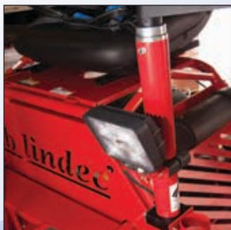
**Мощные LED-лампы** (4x15Вт) – две спереди и две сзади - улучшают видимость при работе в темное время суток
